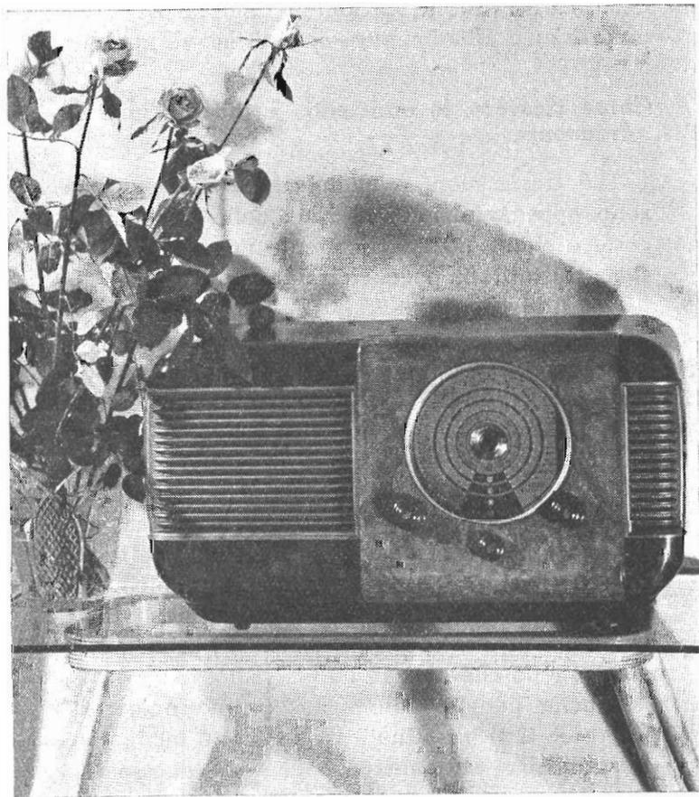
Fig. 12.3. - Apparecchio AM/FM ossia a modulazione di ampiezza (per la ricezione delle emittenti ad onde medie, corte e cortissime) ed a modulazione di frequenza (per la ricezione delle emittenti ad onde ultracorte). Possiede 12 valvole più l'occhio magico.
